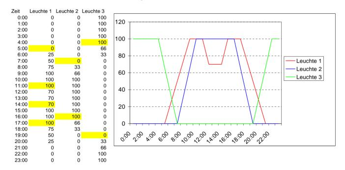
Es ist der Helligkeitsverlauf von 3 Leuchten zu sehen. Leuchte 1 sei mit einer rötlichen, farbintensivierenden Röhre bestückt, Leuchte 2 mit einer weißen Röhre und Leuchte 3 mit einer Mondlichtröhre. Leuchte 4 wird in diesem Beispiel nicht verwendet.
