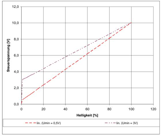
Um einen optimalen Verlauf der Dimmung zu erreichen kann im Menü *Manuelle Helligkeit* getestet werden, ob sich bei den unteren Dimmwerten die Helligkeit ändert oder die Leuchte abschaltet und bei den oberen Dimmwerten auch noch Unterschiede in der Helligkeit erkennbar sind. Gegebenenfalls die Steuerspannungen ändern und erneut testen.
