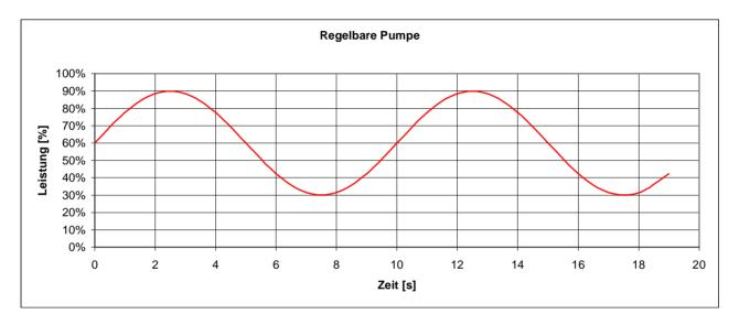
Zusätzlich zur Wellenerzeugung kann ein abwechselndes Schalten der Pumpen (z.B. *Sequenz* oder *Zufall*) eingestellt werden. Die gerade aktiven Pumpen erzeugen die eingestellten Wellen, die inaktiven Pumpen laufen mit der eingestellten Mindestleistung.
