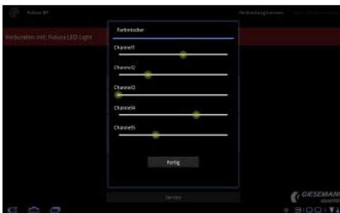
Analog zur weiter oben bei den Einstellungen zum Tagesverlauf beschriebenen Struktur öffnet sich zunächst ein Dialog, der das in Ihrer Leuchte verfügbare LED-Board anzeigt (**#0Master**). Wählen Sie dieses oder **#alle** aus. Hier kann sodann das Farbzusammenspiel der einzelnen Farbkanäle getestet werden. Durch Bewegen der Schieberegler werden die einzelnen Kanäle in Ihrer Intensität verändert. Somit lassen sich in Echtzeit über Ihrem Aquarium unterschiedlichste Farbkombinationen ausprobieren.
